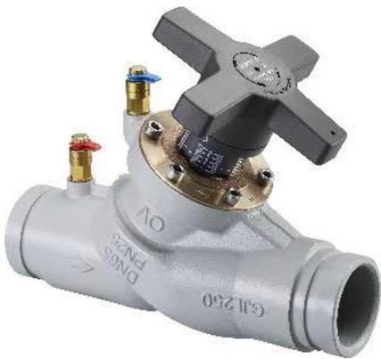
Le robinet d'équilibrage avec raccord rainuré HydroControl VGC sert à l'équilibrage hydraulique statique des colonnes dans les installations de chauffage et de rafraîchissement à circuits fermés. Il offre une fonction de mesure via le siège du robinet.
