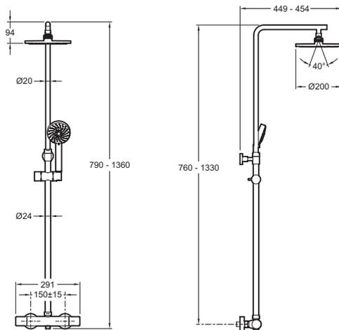
Descriptif CCTP : Colonne de douche thermostatique. E24322. Collection : BRIVE. TYPE D'INSTALLATION : Mural. NORMES ET RÉGLEMENTATIONS : NF : E1/1 C3 A1 U3 // ACS : 19ACCLY836. ECO CONSO : eco d'eau. AVEC OU SANS ROBINETTERIE : AVEC ROBINETTERIE. TYPOLOGIE DE ROBINETTERIE DE DOUCHE : Thermostatique. INVERSEUR : Intégré. BUTÉE DE SÉCURITÉ : 38°C. TEMPÉRATURE MAXI : 50°C. DÉBIT DOUCHETTE : 10 l/mn. NOMBRE DE JETS : 5.
